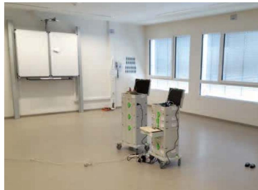
Messanordnung für die Raumlufmessung in einem Schulgebäude
