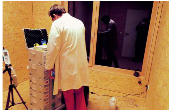
▲ Vergleichende VOC-Messreihen in Gebäuden in Holzrahmenbauweise und unterschiedlichen Bau- und Holzwerkstoffen ergeben wichtige Erkenntnisse über die Raumluftqualität in bestimmten Bauabschnitten. Zudem kann der Einfluss von Verarbeitungs- und Nutzungsfehlern nachgewiesen werden.
