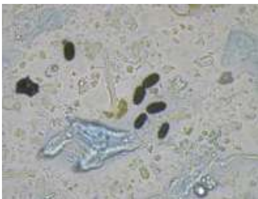
Partikelprüfung mit Raumluftmessgerät/Objekträger (Hautschuppen, Pollen, Mikroorganismen, Fasern)
